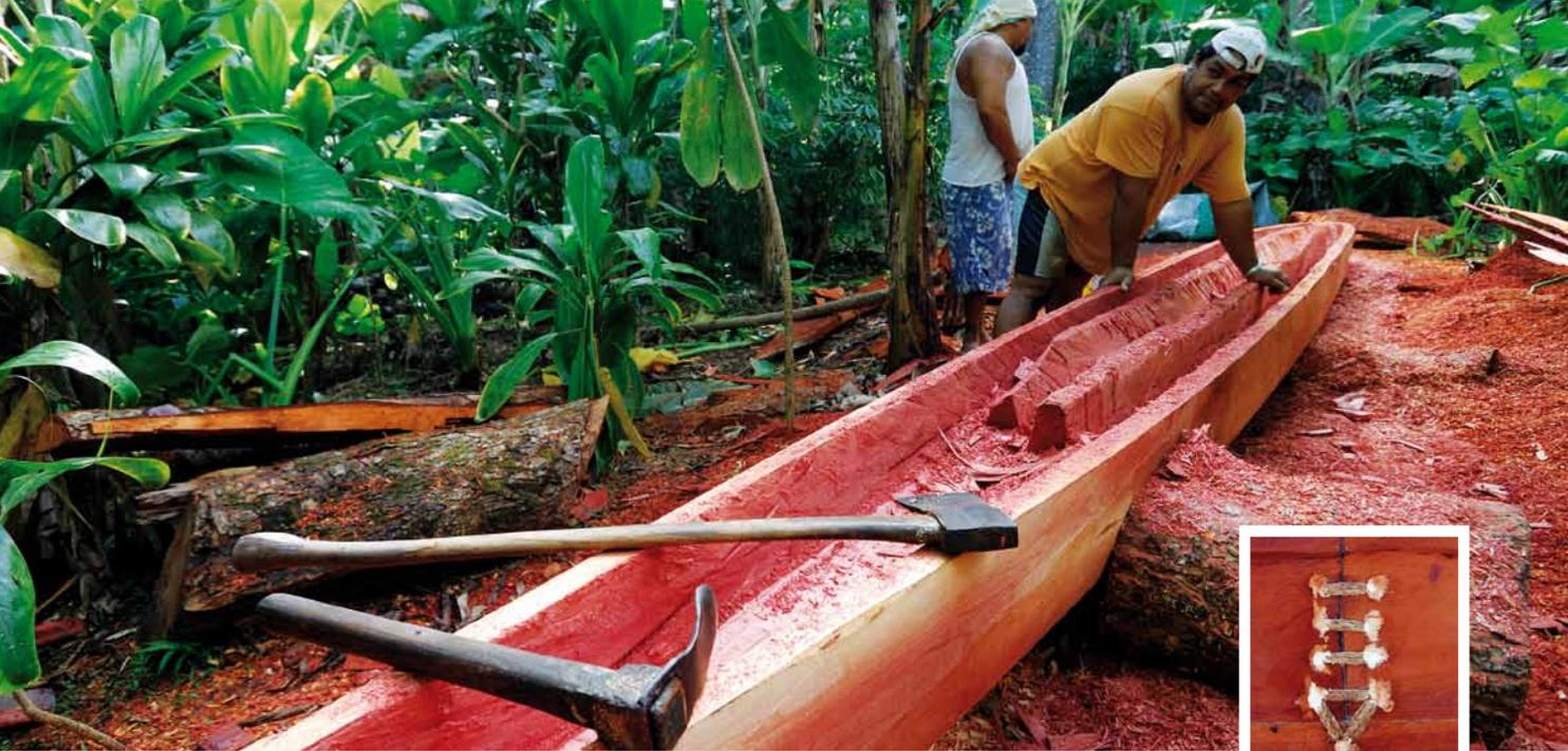
TAILLÉE DANS UN TRONC D'ARBRE, LA PIROGUE VA ÊTRE RÉHAUSSÉE PAR DES PLANCHES COUSUES, À L'ANCIENNE.
